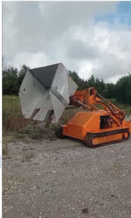
Foto 46 Particolare Benna posizione scarico
